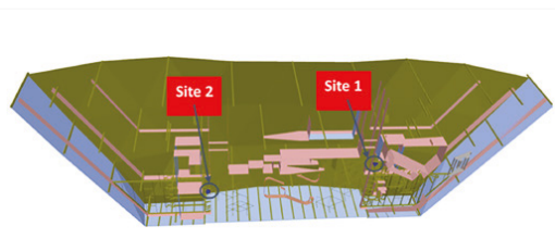
▲ Model zastępczy Voyagera (ukryte warstwy poziome) z optymalnymi lokalizacjami jednostek radiowych
