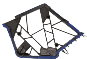
▲ Strukturalna ekspansja kleju (na niebiesko) podczas procesu wypalania BIW ECOAT. CBS™ w pojedynkę.
